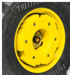
Основной балластировочный груз 70 кг + 900 кг Тяжелый балласт для большой тяги с ободами 42 дюйма и более.
