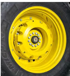
Основной балластировочный груз 70 кг + 1x/2x 205 кг балласта, пригодных для шин всех размеров.
