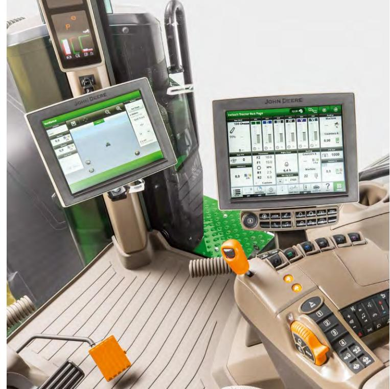
Благодаря логически составленным меню и ёмкой панели быстрого доступа навигация стала еще проще. А с системой Quick Line теперь вы можете записывать маршрут АВ всего одним нажатием кнопки.
