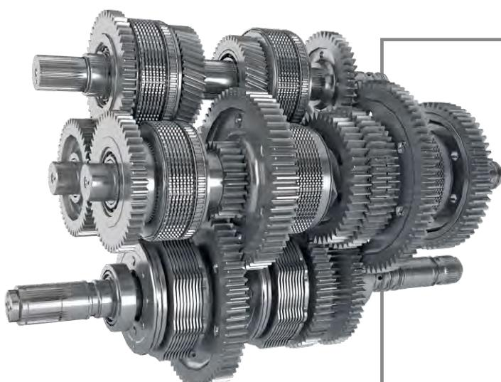
10 передач PowerShift в диапазоне 5–16 км/ч для максимальной силы тяги в поле при оптимальных оборотах. Максимальная скорость достигается при 1 410 об/мин (40 км/ч).
