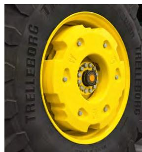
Основной балластировочный груз 70 кг + 530 кг Компактный груз, не выходящий за габариты 2,55 м.
