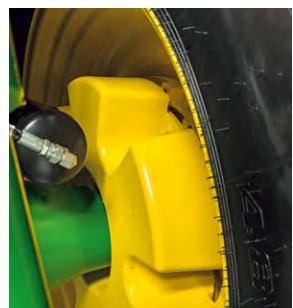
Внутренний груз 625 кг, также возможны версии с тормозами прицепа и дополнительным резервуаром для отбора масла.
