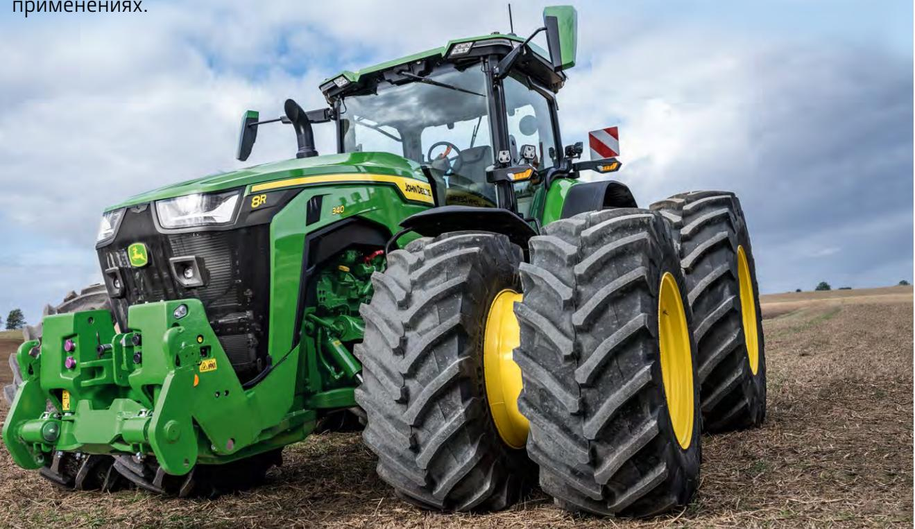
Доступная в качестве опции iTEC-совместимая передняя навеска имеет максимальную грузоподъемность на крюках 5 200 кг.
