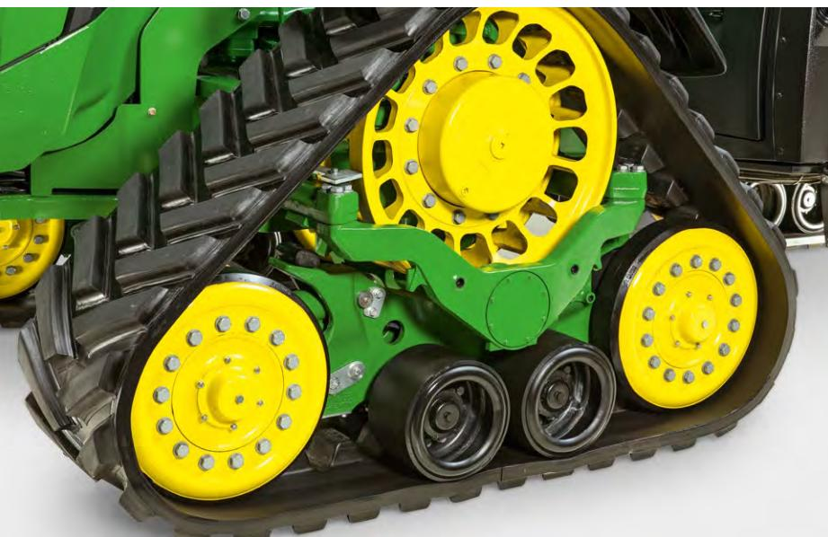
Площадь контакта с землей 4,57 м<sup>2</sup> является образцово-показательной в этом классе мощности. Даже при полной загрузке балластом статическое удельное давление на грунт сзади составляет всего 36 кПа. Повреждение почвы на разворотных полосах практически не наблюдается, хотя радиус разворота даже меньше, чем у колесных тракторов 8R.
