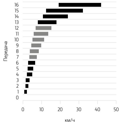
Трансмиссия предоставляет 6 передач от 4 до 12 км/ч, чтобы всегда обеспечивать оптимальную комбинацию передача/обороты двигателя.
